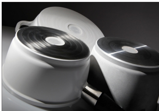
Mittels Kaltgasspritzen erzeugte Beschichtungen auf Kochgeschirr. Coatings on cookware produced by cold gas spraying. (Quelle/Source: obz innovations gmbh, Bad Krozingen)
