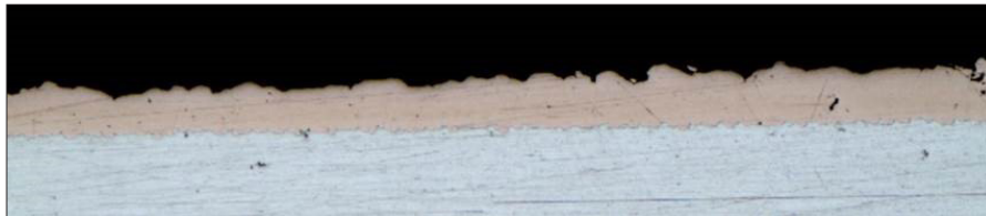
Querschliff durch ein Stromschienensegment. Cross section through a conductor rail segment. (Quelle/Source: Impact Innovation GmbH, Haun/Rattenkirchen)
