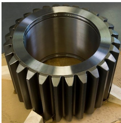
Bild 1: Planetenrad mit Molybdän beschichtet und mechanisch fertig bearbeitet
