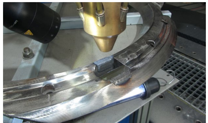
Bild 4: Reparierte Kreismesseraufnahme, laserbeschichtet, holzverarbeitende Industrie Fig. 4: Repaired Circular Knife Holder, Laser Coated, Woodworking Industry
