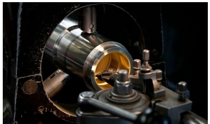
Bild 2: Bronze-Innenbeschichtung durch drehen mechanisch fertig bearbeitet Fig. 2: Bronze inner coating finished mechanically by turning
