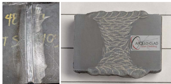
Bild 6. Handgeführtes Laserschweißsystem eines Stumpfstößes mit Spalt vor dem Schweißen (links) und geätzter Querschnitt der Schweißnaht (rechts), (mit freundlicher Genehmigung von Apollo Machine, Kanada)
