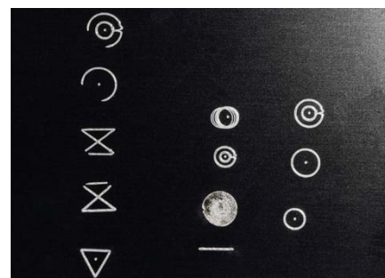
Bild 4. Strahlpendelfiguren beim zweiachsigem Strahlpendeln: Gravur auf eloxiertem Blech (links) sowie gemessene Energieverteilung (Mitte und rechts)
