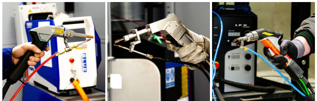
Bild 3. Handstücke zum einachsigen (links) und zweiachsigen (Mitte) Pendeln sowie mit aktiver Plasmaüberwachung (rechts)
