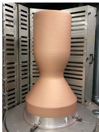
Abbildung 4: Kaltgasgespritzte Cu-Legierung – Innenmantel und In625-Ummantelung obenauf von ArianeGroup [2]
